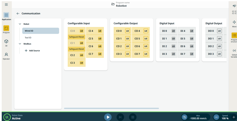
Slika 1.2: Komunikacijski zaslon prikazuje V/I.
